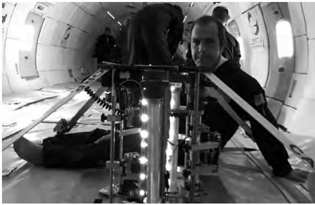
Abb.1: Sedimentationsversuche während Parabelflug im Rahmen des MarsSedEx Programms
