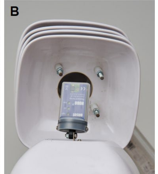
Abb.1: Temperaturmessgeräte im Wandel der Zeit. (A) Die Messgeräte in der Wetterhütte der 1970er-Jahre und (B) die aktuelle Low-Cost-Messstation Marke Eigenbau (Mathys, 1976; P. Duschletta).
