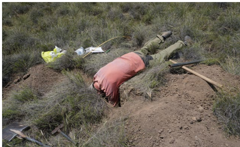
Die Profilgrube sollte ausreichend gross sein. So dass man die Bodenhorizonte sehen kann, ohne dabei den Kopf in den Sand stecken zu müssen. Bild: Juliane Krenz
