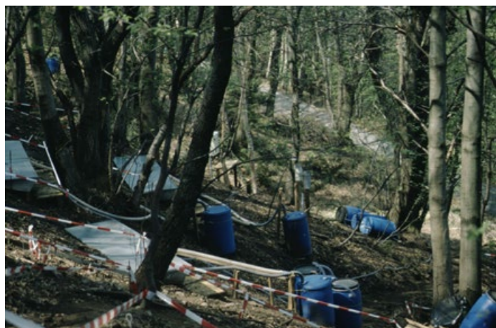
Abbildung 1: Bodenerosionsmessung im Tessin 1998: Bei St. Antonino wurde ein Stück Kastanienwald angezündet, die Feuerwehr sicherte den Hang darüber mit einem Wasservorhang ab, im Anschluss wurden Erosion, Wasser- und Nährstoffhaushalt beobachtet (Aufnahme: Christoph Wüthrich)
