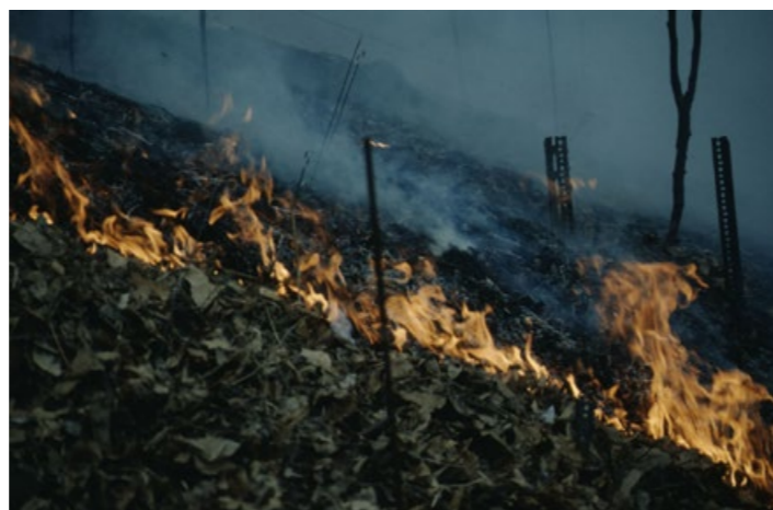
Abbildung 1: Bodenerosionsmessung im Tessin 1998: Bei St. Antonino wurde ein Stück Kastanienwald angezündet, die Feuerwehr sicherte den Hang darüber mit einem Wasservorhang ab, im Anschluss wurden Erosion, Wasser- und Nährstoffhaushalt beobachtet (Aufnahme: Christoph Wüthrich)
