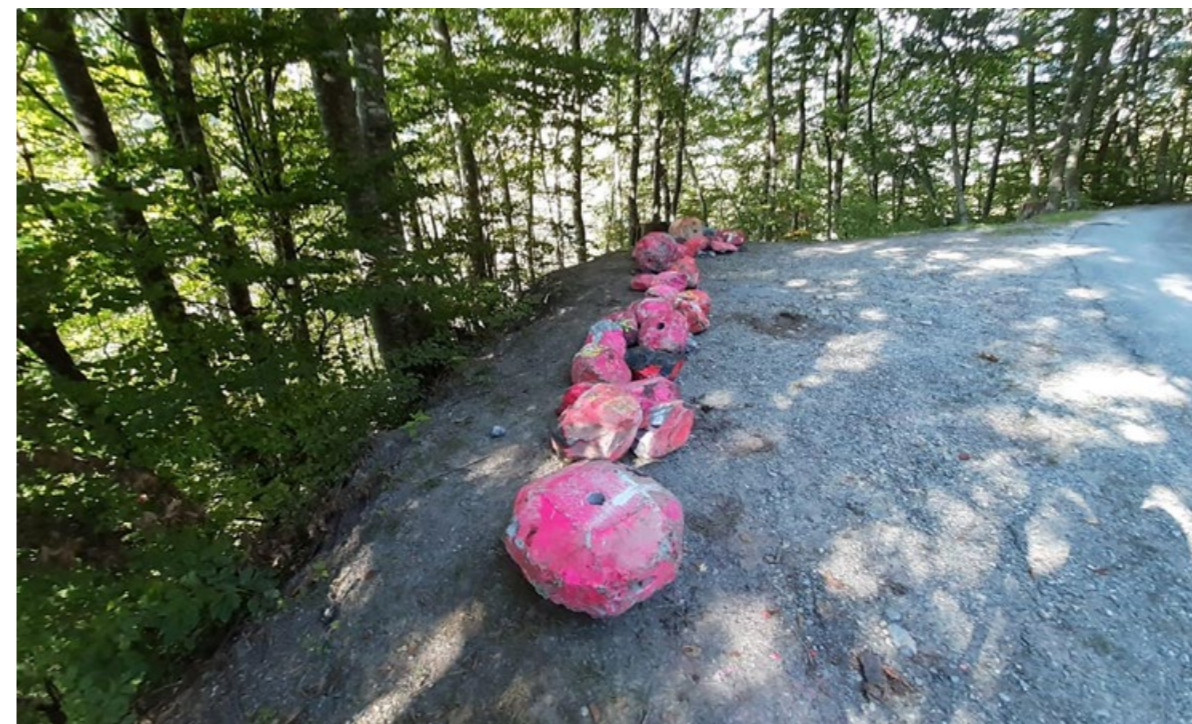
Abbildung 2: Die «Rolling Stones» der WSL: Präparierte Steine für einen Versuch im Jahr 2020 mit 200 Steinen im Schraubachtobel in Schiers (GR) und (unten) ein Stein im Anflug. Quelle: https://www.wsl.ch/de/2020/09/200-steine-in-12-tagen.html .
