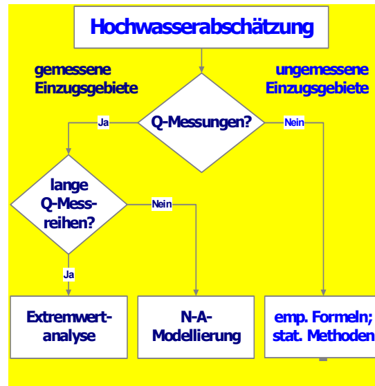
Abbildung: Grundsätzliches Vorgehen bei der Hochwasserabschätzung (Q: Abfluss; N-A: Niederschlag-Abfluss)
