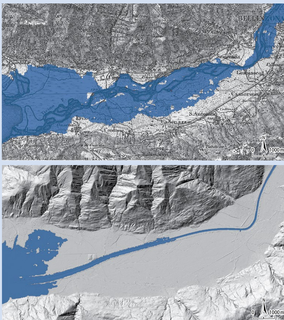
Fig. 52: Comparaison des surfaces inondées de l'événement de crue de 1868 reconstitué par le modèle hydraulique (en haut) et les répercussions simulées du même événement sur la situation actuelle (en bas).
