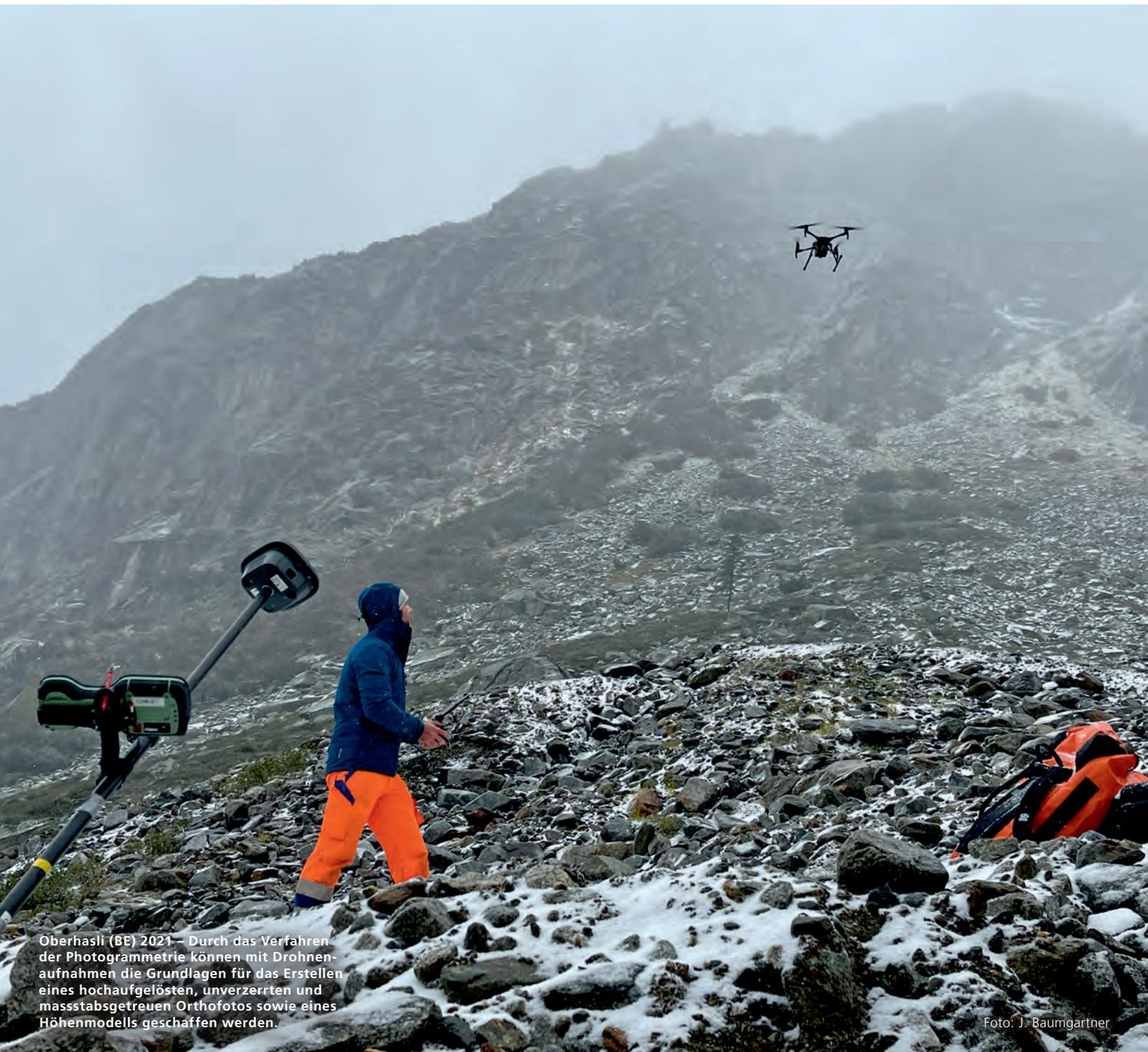
Oberhasli (BE) 2021 – Durch das Verfahren der Photogrammetrie können mit Drohnen-aufnahmen die Grundlagen für das Erstellen eines hochauflösenden, unverzerrten und maßstabstgetreuen Orthofotos sowie eines Höhenmodells geschaffen werden.
