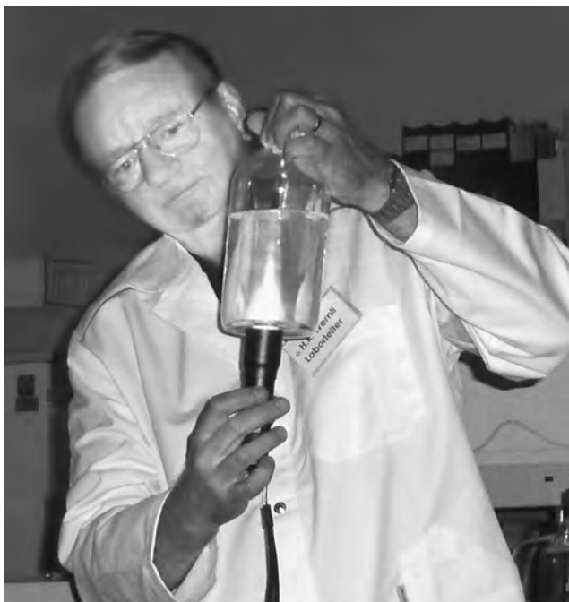
Tag der offenen Tür: Uranin fluoresziert bei hohen Konzentrationen sichtbar. Es kann aber mit einem Spektrometer bis zum 30'000fachen unter der Sichtbarkeitsgrenze nachgewiesen werden.
